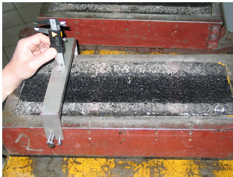
Rys.3.4. Pomiar głębokości koleiny w wybranych punktach.
