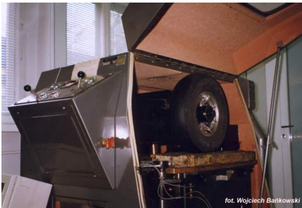
Rys.3.1. Typowy aparat do badania odporności mieszanek mineralno-asfaltowych na koleinowanie.
