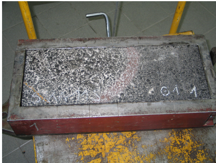
Rys.3.2. Próbkę przygotowana do badania odporności na koleinowanie.
